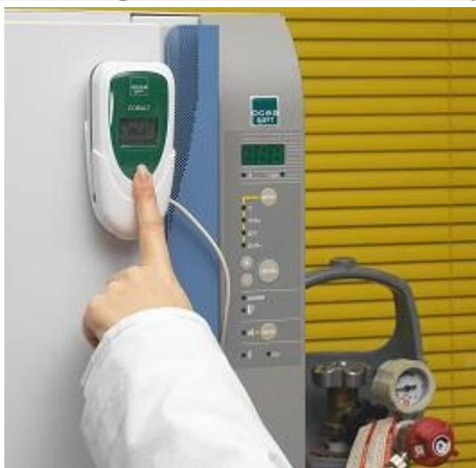
Installation aisée avec le support aimanté, mise en route automatique grâce au SDP. Un appui de trois secondes sur le bouton enclenche la connexion avec le récepteur.
