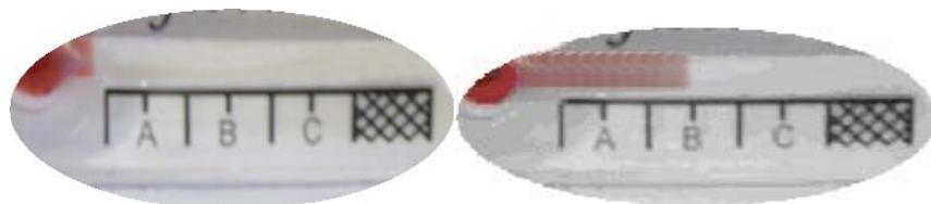
L'indicateur vous signale tout dépassement de température montante avec la prise en compte de l'accumulation du temps de dépassement
